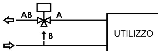
d) Miscelazione a portata costante all'utilizzo in circuiti ad iniezione o spillamento
